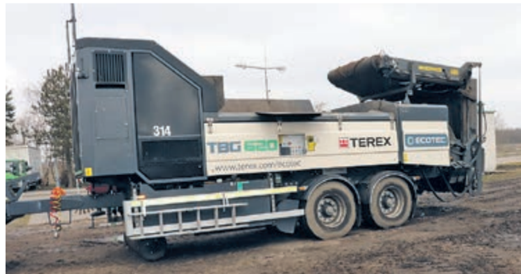
Mobilny rozdrabniacz wysokoobrotowy do odpadów zielonych
